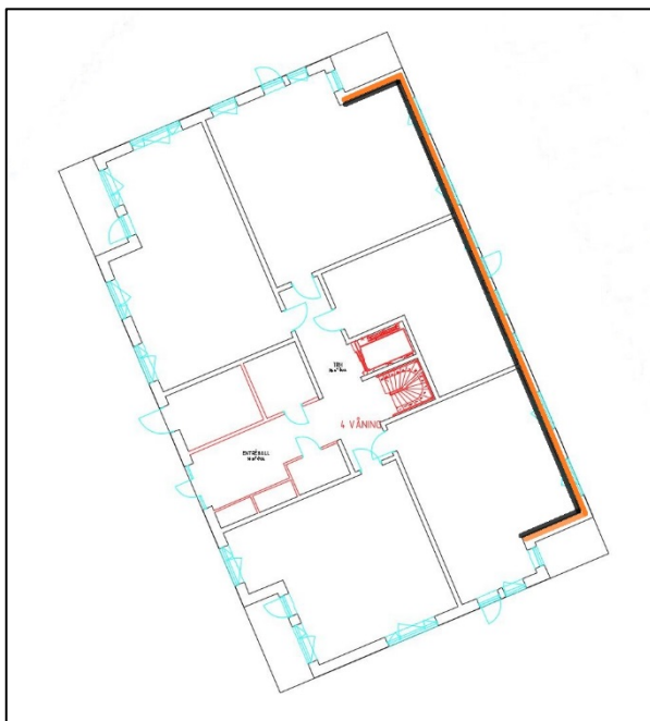
Figur 4. Bullrig fasad (orange/svart markering), plan 3 och 4, ekvivalent ljudnivå 55-60 dBA
